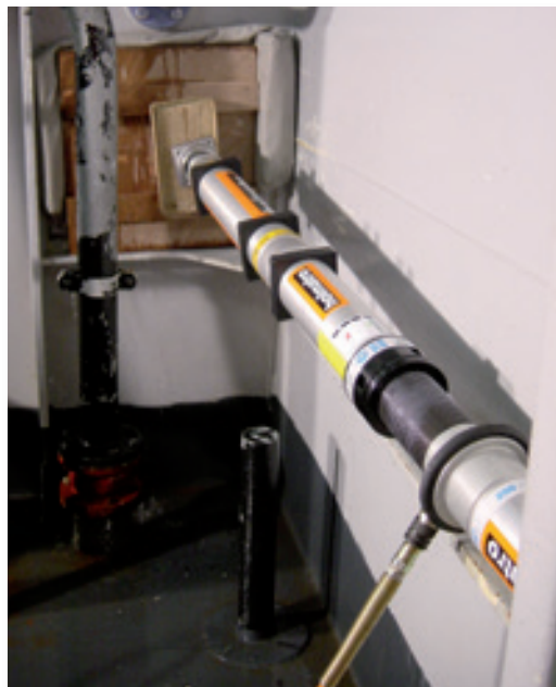
Colmatage d'une fuite dans une cloison mitoyenne avec le système hydraulique d'épontillage pour la sécurité navale PowerShore.
