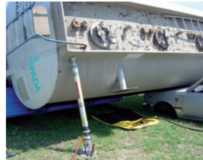
Étai pneumatique à verrouillage automatique pour un suivi d'étaillage dans des opérations de levage de véhicules lourds.
