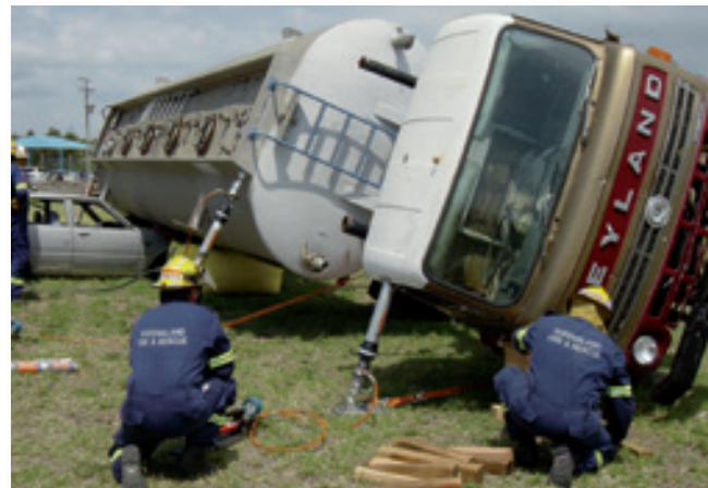
Étai hydraulique à verrouillage automatique utilisé pour le levage et l'étaillage sur véhicules lourds.
