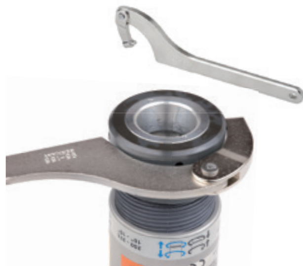
L'étau fileté manuel est utilisé pour étayer une fenêtre. Il peut être sécurisé à l'aide d'une clé à ergots (voir image ci-dessous).
