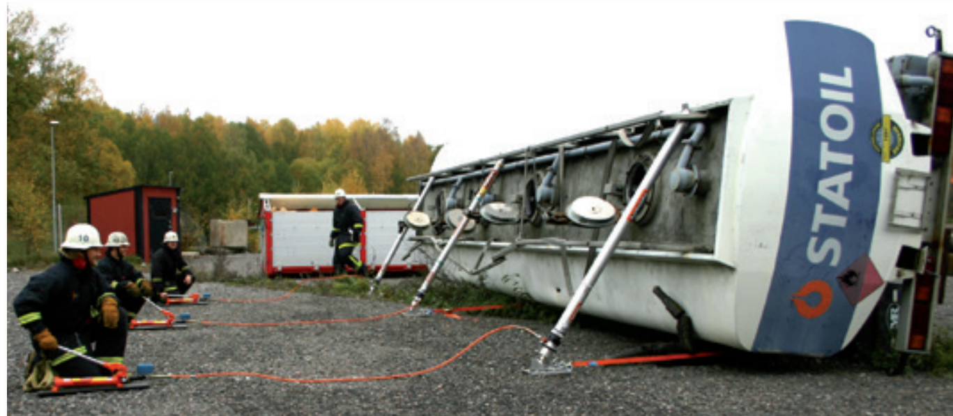
Étayage et levage de véhicules de transport de marchandises lourdes avec un système PowerShore hydraulique.
