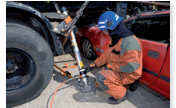
Stabilisation de véhicule lourd avec étau hydraulique à verrouillage par contre-écrou.
