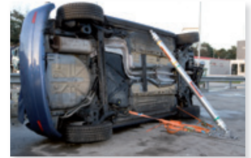
Rallonges, têtes et plaque de base utilisées pour la stabilisation de véhicules légers.
