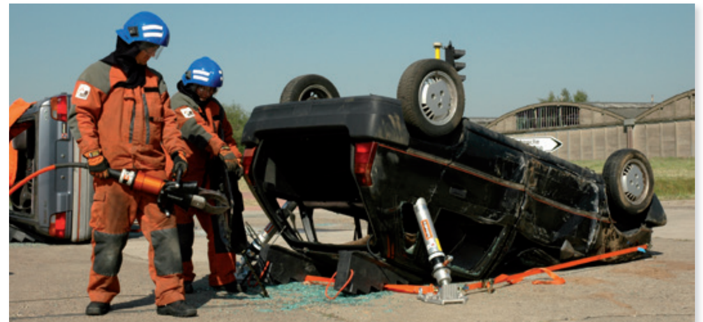
Deux étais hydrauliques utilisés pour la stabilisation de véhicules légers et, si nécessaire, pour un levage contrôlé.
