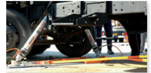
Stabilisation de véhicule lourd avec étau hydraulique à verrouillage par contre-écrou.
