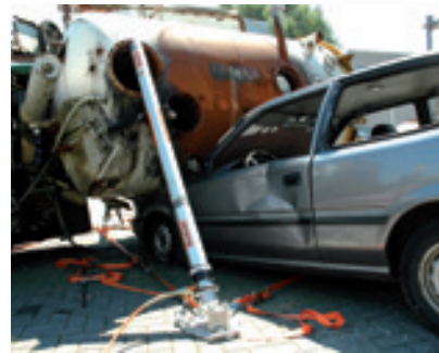
Stabilisation de véhicule léger avec étais hydrauliques à verrouillage par contre-écrou.
