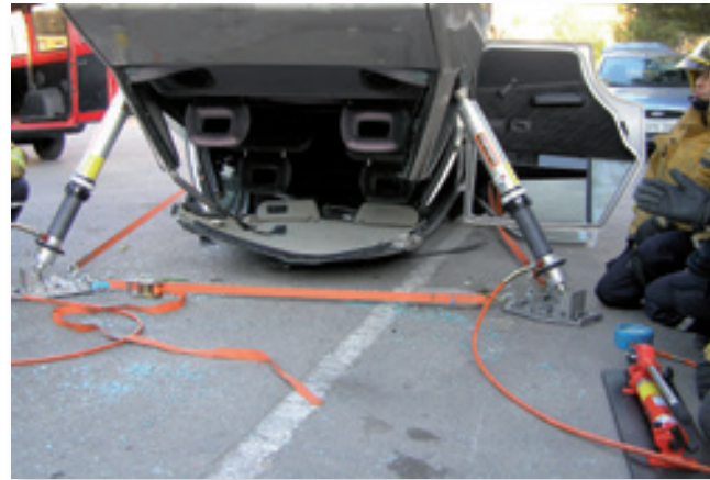
Stabilisation de véhicule léger avec étais hydrauliques à verrouillage par contre-écrou.
