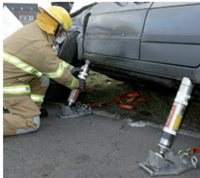
Stabilisation de véhicule avec étais manuels à verrouillage par contre-écrou.
