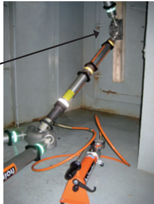
Une tête à pivot à 3 axes et un bloc à 2 axes pour utilisation plusieurs lignes d'épontillage dans différentes directions.
