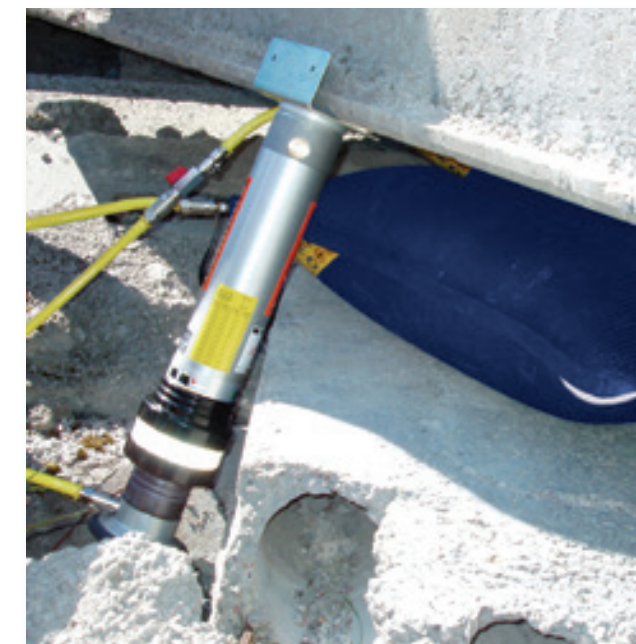
Étau à verrouillage automatique utilisé pour seconder un coussin de levage.
