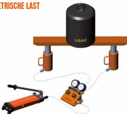
Empfohlene Zylinderkapazität insgesamt = 1,5 x Last
