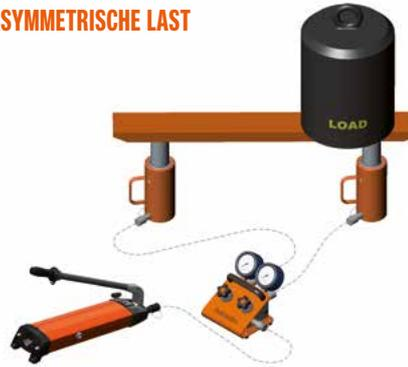
Empfohlene Zylinderkapazität insgesamt = 2 x Last
