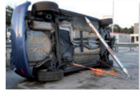
Verlängerungsrohre, Auflager und Bodenplatte, die zum Stabilisieren eines Personenwagens benutzt werden.
