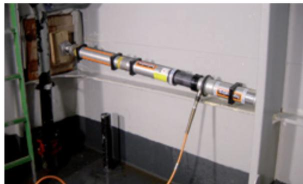
Hydraulische Stützen werden mit Verlängerungsrohren, Auflagern und Holz benutzt, um eine undichte Stelle an Bord abzudichten.
