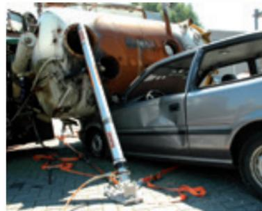
Stabilisierung eines schweren Fahrzeugs mit hydraulischen Stützen mit Sicherungsmutter.
