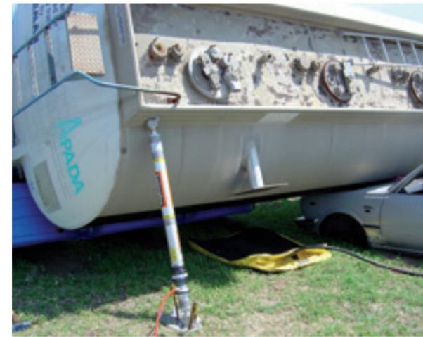
Pneumatische Auto-Lock Stützen, die zum nachlaufenden Stützen beim Heben eines schweren Fahrzeugs benutzt werden.
