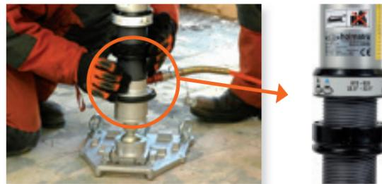
Eine Last, die durch eine handbediente Sicherungsmutter gesichert wird.
