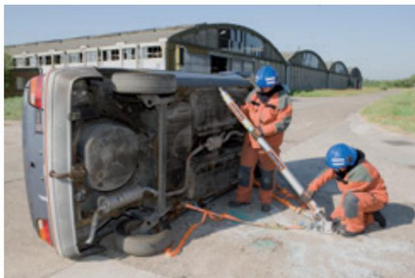
Stabilisierung eines Fahrzeugs in Seitenlage.
