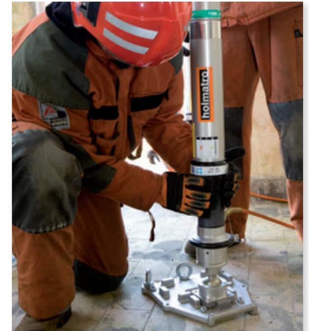
Pneumatische Stütze mit Sicherungsmutter als mechanische Stütze bei einem eingestürzten Gebäude.
