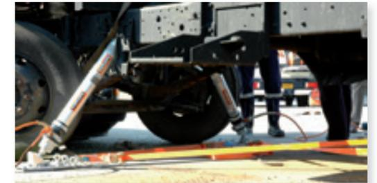
Stabilisierung eines schweren Fahrzeugs mit einer hydraulischen Stütze mit Sicherungsmutter.
