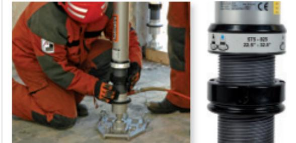
Das System mit Sicherungsmutter wird mit der Hand, mithilfe einer Sicherungsmutter gesichert. Da hierbei keine zusätzlichen Kräfte erzeugt werden, ist dieses System eine gute Möglichkeit bei z.B. eingestürzten Gebäuden, wo die bereits vorhandenen Kräfte nicht gestört werden dürfen, um nochmaliges Einstürzen zu verhindern. Alle Stütztypen können mit einem System mit Sicherungsmutter ausgestattet werden.
