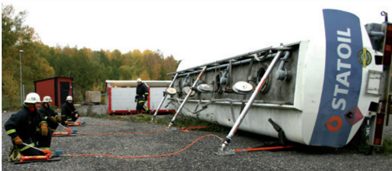
Das Stützen und Heben eines Tankwagens mit einem hydraulischen PowerShore System.
