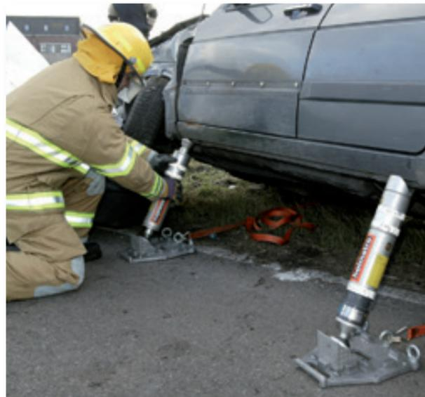
Fahrzeugstabilisierung mit mechanischen Stützen mit Sicherungsmutter.
