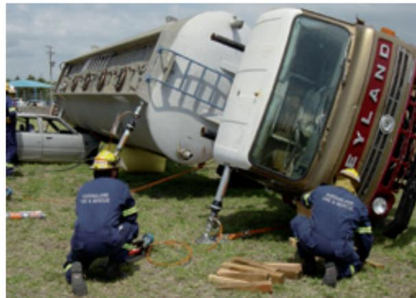
Das Stabilisieren und Heben eines schweren Fahrzeugs mit Auto-Lock Stützen.
