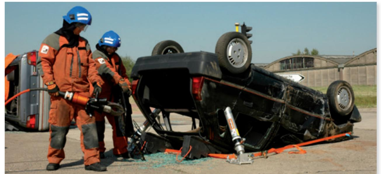
Zwei hydraulische Stützen, die zum Stabilisieren und, wenn notwendig, zum kontrollierten Heben eines Personenwagens benutzt werden.
