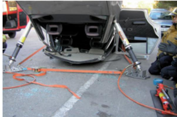
Stabilisierung eines Personenwagens mit hydraulischen Stützen mit Sicherungsmutter.
